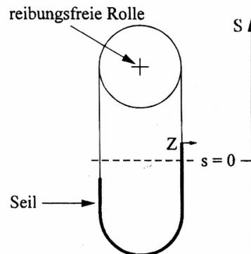
In einem Meßversuch wird für Seile verschiedener Länge  $\ell$  die Abhängigkeit der Periodendauer  $T$  des Pendels von der Länge  $\ell$  des Seils und der Amplitude  $\hat{s}$  der Schwingung untersucht. Es ergibt sich folgende Meßreihe:
